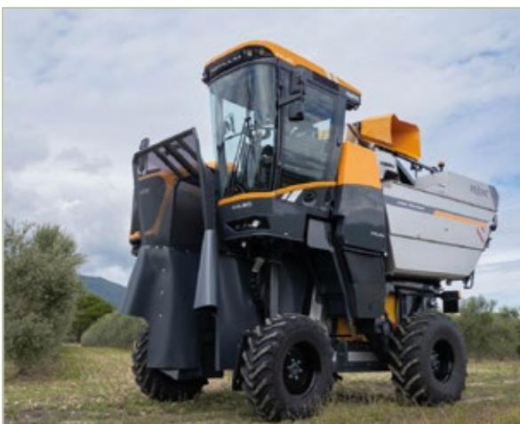
PELLENC présente l'**OPTIMUM XXL80**, automotrice polyvalente pour vigne, oliviers et amandiers avec têtes de récolte interchangeables. Confort, sécurité et ergonomie sont optimisés. Connectée à PELLENC CONNECT, elle offre accès en temps réel aux données machines et agronomiques. Sa pesée embarquée Dynamic assure un suivi précis et continu des récoltes, pour une agriculture performante, durable et intelligente.
