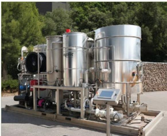
PELLENC lance **SMART WINELYSE**, solution innovante de désalcoolisation des vins par évaporation partielle sous vide, applicable sur moûts ou vins finis. Développée avec l'IFV, INRAE et CRITT, elle préserve arômes et couleurs, crée de nouveaux profils gustatifs, et valorise l'alcool extrait. Compacte et mobile, la machine réduit jusqu'à 6% vol d'alcool en un passage, sans altérer l'équilibre gustatif.
