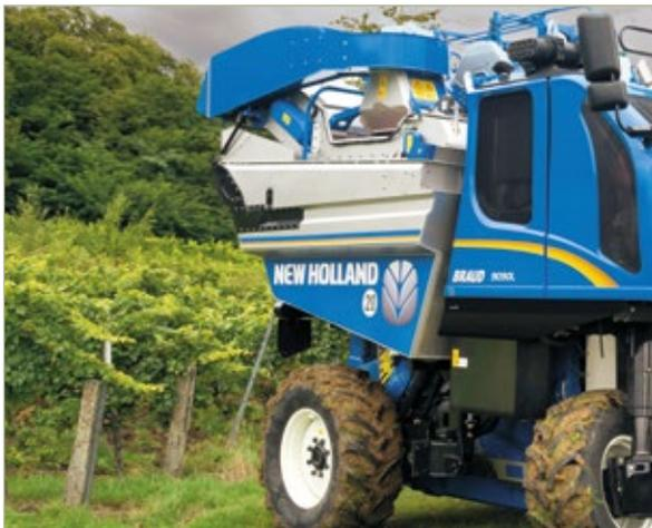
Le système **Vari-Control** assure un nivellement automatique de la machine en permanence dans les phases de travail de 0 à 13 km/h. Il offre également une progressivité et une rapidité dans la vidange des bennes permettant un gain de productivité. La sécurité de l'opérateur dans les phases de tournière est sensiblement améliorée dès que l'opérateur active ce système.
