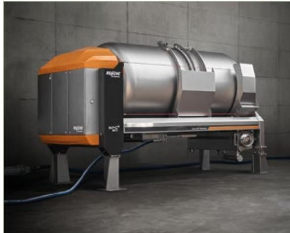
Le presseur **SPC<sup>2</sup>** de **PELLENC PERA OENOPROCESS** allie performance œnologique, simplicité et technologie connectée. Équipé d'un écran tactile intuitif, il sécurise le remplissage, automatise le pressurage et assure une extraction douce grâce aux grilles Fast Press. Son système Easy Clean optimise le nettoyage. Connecté à Pellenc Connect, il offre pilotage à distance, traçabilité et options avancées pour maîtriser la qualité.
