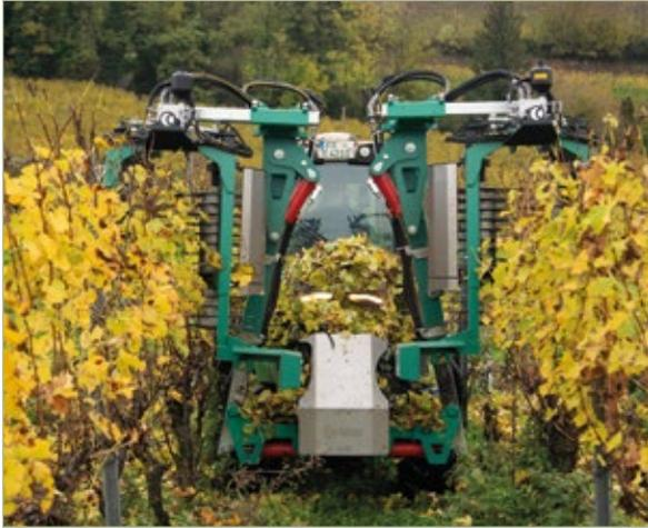
Le **C-VISION Pre-pruner** de CLEMENS est un taille-avant double rangée équipé d'un système d'ouverture automatique basé sur caméra et IA, adaptable à tout type de piquet. Ce système évolutif s'entraîne à de nouvelles configurations. Il associe une taille réglable en hauteur (49-95 cm) sur un mât TWINPEAKS avec ajustements d'angle et de largeur. Commande hydraulique proportionnelle et joystick SMARTI assurent un positionnement précis. Vitesse moyenne : 7 km/h.
